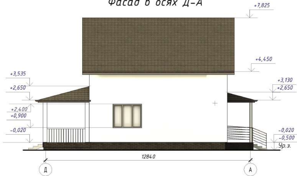
Фасад в осях Д-А
